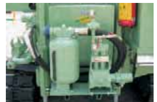
Pompa schiuma e lubrificatore per martello fondo foro. Foam pump and DTH hammer line lubricator. Pompe à mousse et lubrificateur pour marteau fond de trou. Schaumpumpe und Öler für Imlochhammer. Bomba de espumante y lubricador en línea para martillo en fondo.
