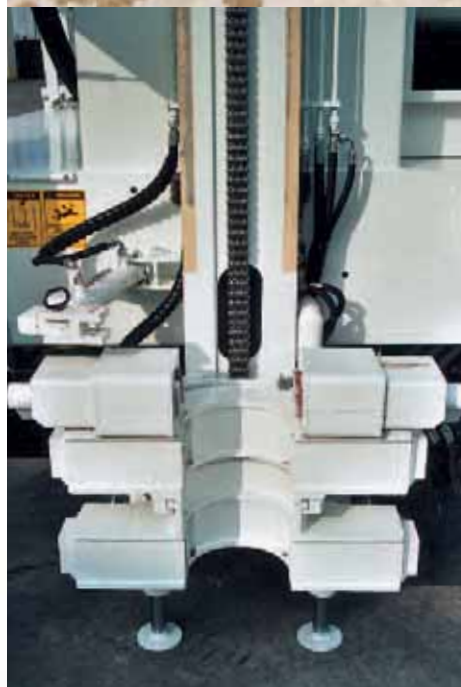
Doppia morsa, rulli di guida idraulici, cilindri estrattori. Double clamp, hydraulic roller guides, pulling cylinders. Double mors, rouleaux-guide hydrauliques des tiges, extracteurs hydr. pour tubages. Doppelabfangvorrichtung, hydr.-Führungswalzen, Rohr-ziehvorrichtung. Mordaza doble, rodillos de guía hidraulicos, cilindro extractor.
