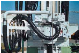
Testa di rotazione a 2 velocità. 2-speeds rotary head. Tête de rotation à 2 vitesses. 2-Geschwindigkeiten Drehkopf. Cabeza de rotacion de 2 velocidades.
