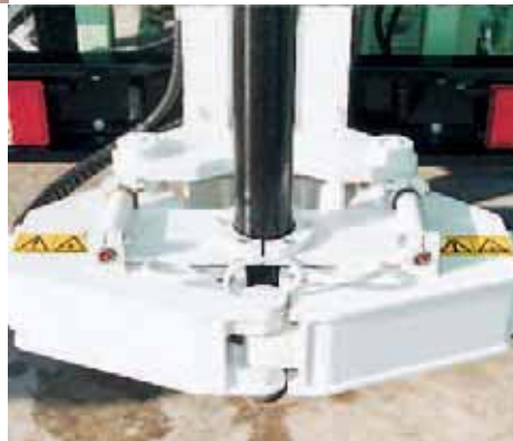
Morsa semplice e guida per aste. Simple clamp and drill pipes centralizer. Mors simple avec centreur des tiges. Einfachabfangvorrichtung mit führungstüren. Mordaza simple y centrador de barras.
