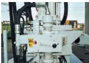
Testa di rotazione a 4 velocità. 4-speeds rotary head. 4-Geschwindigkeiten Drehkopf. Tête de rotation à 4 vitesses. Cabeza de rotacion de 4 velocidades.
