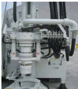
Testa di rotazione con mandrino e iniezione aria per circolazione inversa. Rotary head with drill pipes chuck and reverse circulation air injection. Tête de rotation avec mandrin pour tiges et injection air pour circulation inverse. KDK mit Bohrgestänge Spannkopf und Luft Injektion für Indirektem Spülung. Cabeza de rotacion con mordaza para tubería y inyección aire por circulación inversa.
