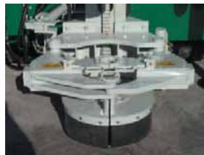
Morsa semplice, cilindro svita aste e parapolvere.
