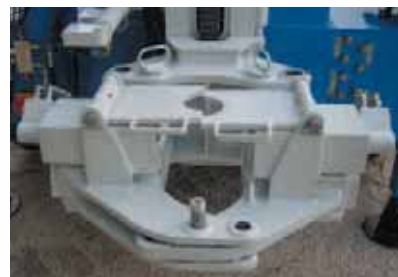
Morsa semplice, rulli guida aste e portelli di sicurezza.
