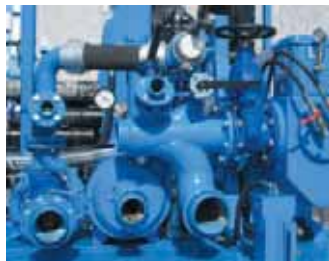
Pompa in aspirazione e collettore per circolazione diretta/inversa. Vacuum pump and manifold for direct/reverse circulation. Pompe en aspiration et collecteur air/boue pour circulation directe/inverse. Direktem/Indirektem Spülung Saugpumpe mit Luft/Schlammsammler. Bomba de aspiracion y colector para circulación directa e inversa.
