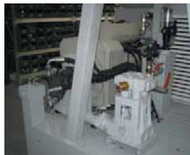
Pompa schiuma e lubrificatore per martello fondo foro. Foam pump and down-the-hole hammer line lubricator. Pompe à mousse et lubricateur pour marteau fond de trou. Schaumpumpe und Öler für Imlochhammer. Bomba de espumante y lubricador en línea para martillo en fondo.
